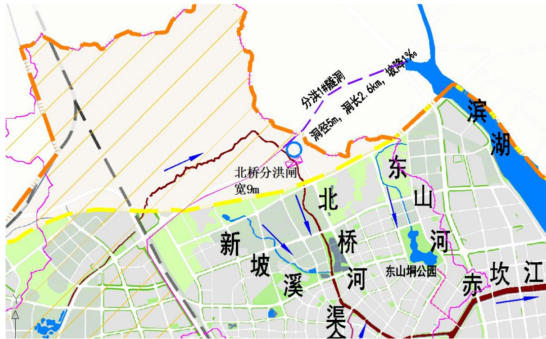
北桥河防洪工程平面布置
