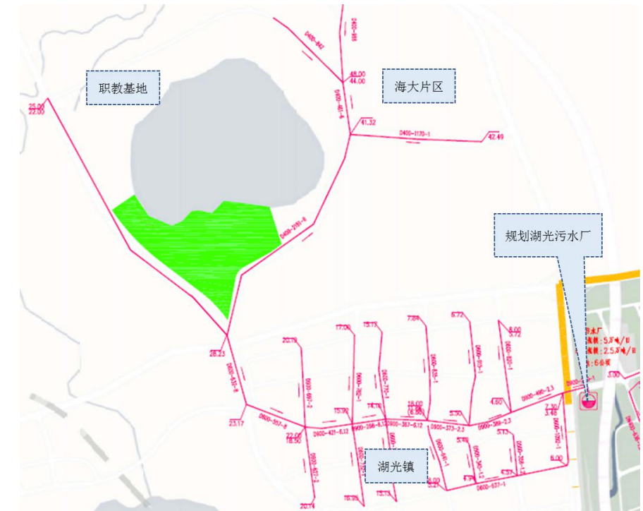
湖光污水厂及配套管网布局图
