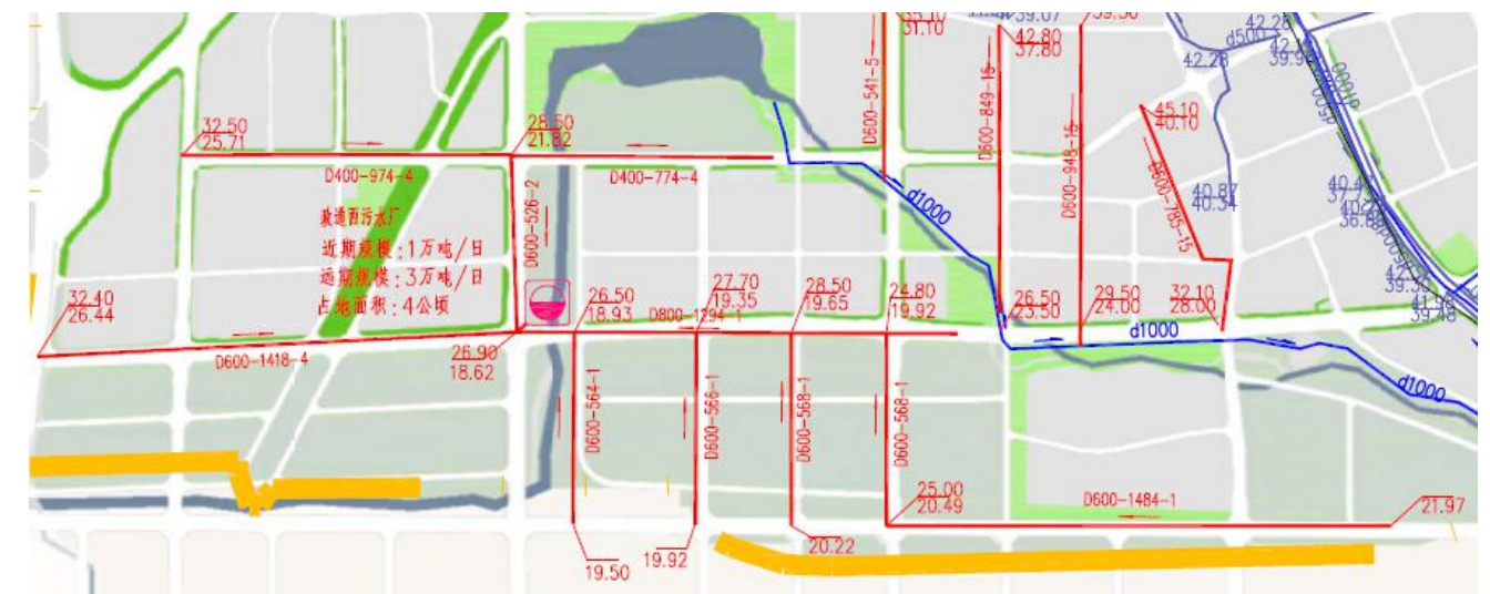
政通西污水厂及配套管网布局图
