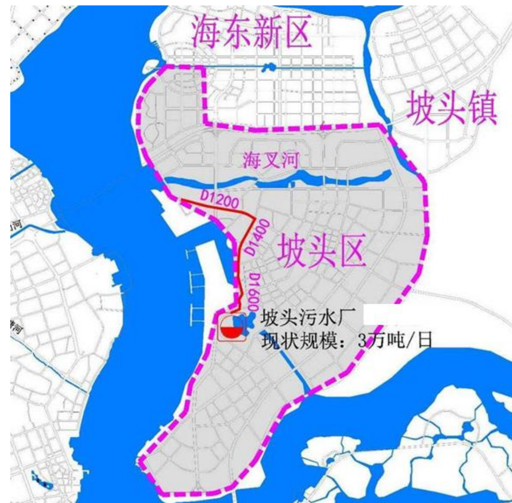
坡头污水厂现状系统图
