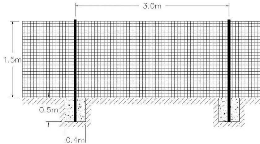
图 5-2 铁丝网示意图
