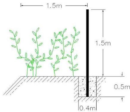
图 5-1 生物隔离带示意图
