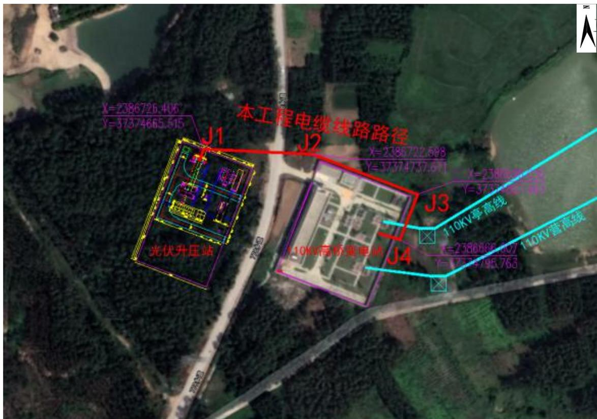
图 2-3 湛江 110 千伏廉江通威渔光互补项目接入系统工程线路路径图
