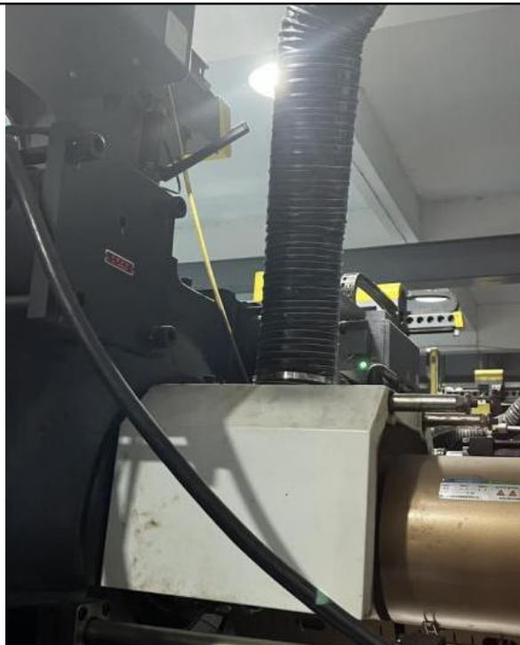
图 4-1 注塑废气包围型集气罩效果照片（图样）
