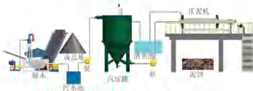
图 4-2 污水处理单元示意图
