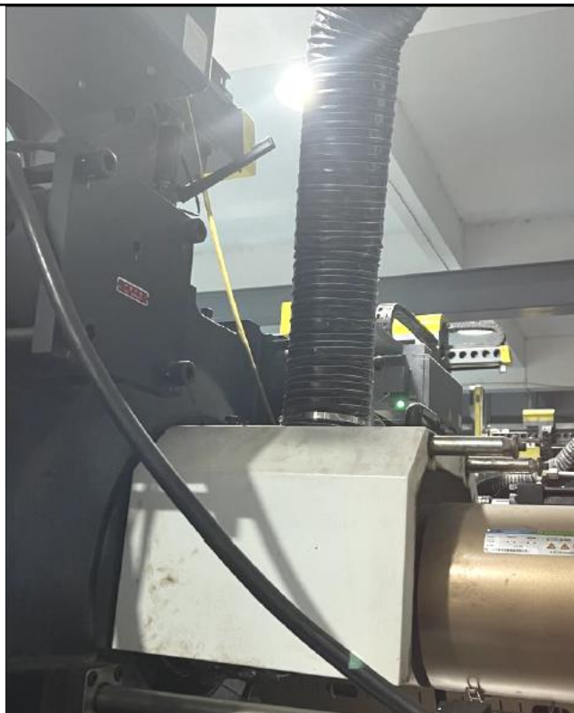
图 4-1 项目包围型集气罩效果照片
