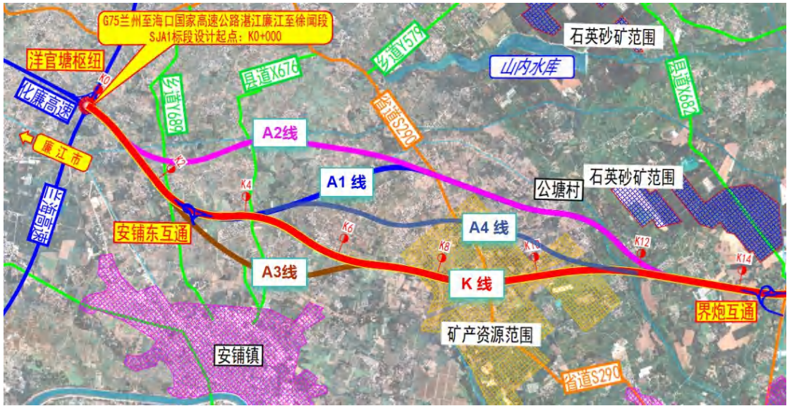
图 3.1-3 起点至界炮镇路段初测路线方案图
