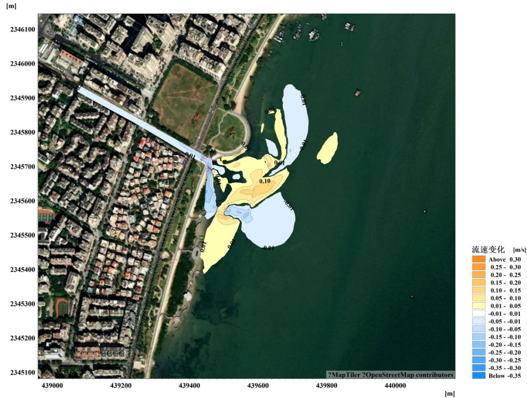
图 5.1.2-13 工程前、后涨急时刻流速变化等值线图（闭闸）（工程后-工程前）
