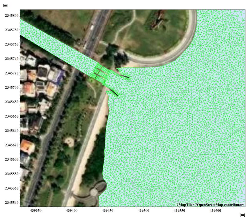
图 5.1.1-4 本项目实施后项目海域网格剖分示意图（闭闸）
