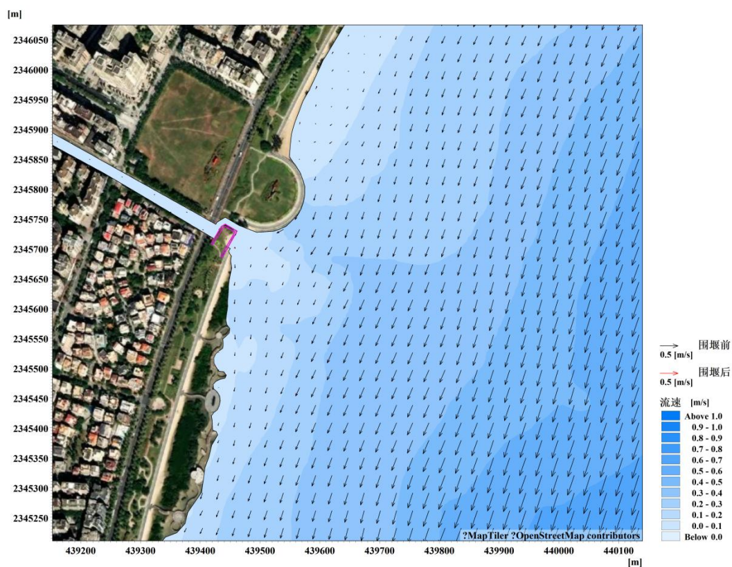
图 5.1.2-11 施工期围堰前、后落急时刻项目附近海域流场对比图
