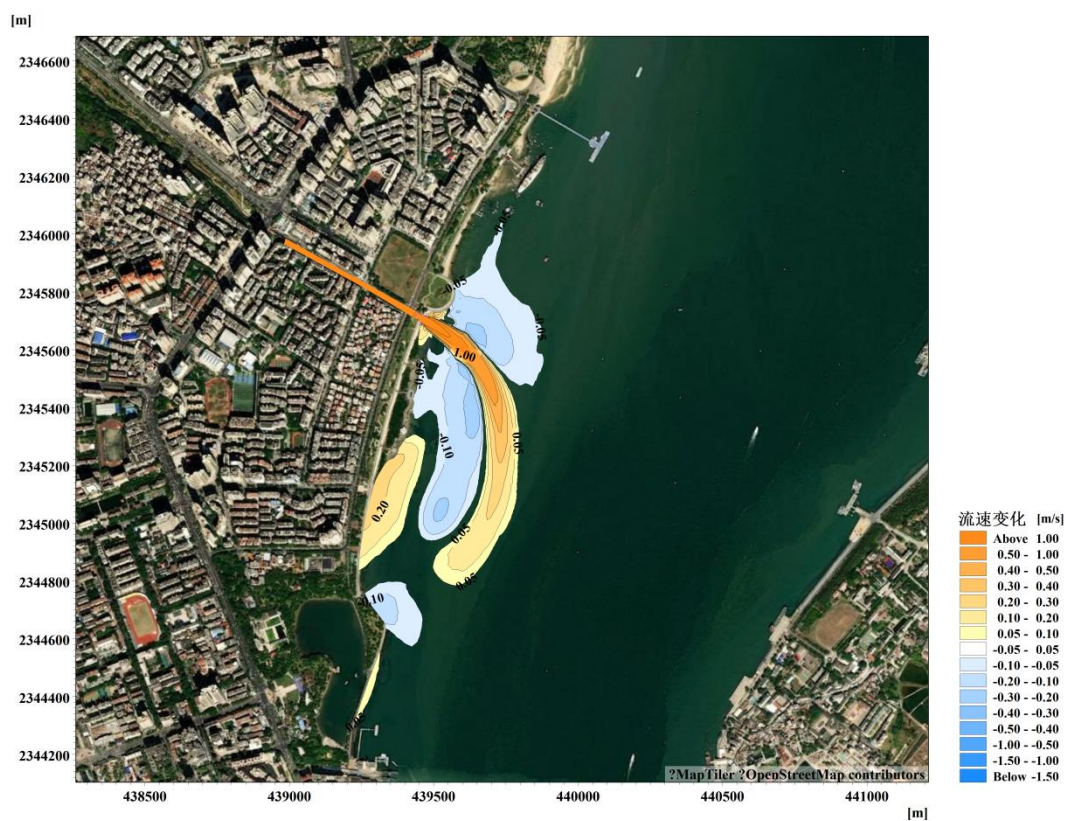
图 5.1.2-18 工程前、后落急时刻流速变化等值线图（开闸，设计流量 126.82\text{m}^3/\text{s} ）（工程后-工程前）
