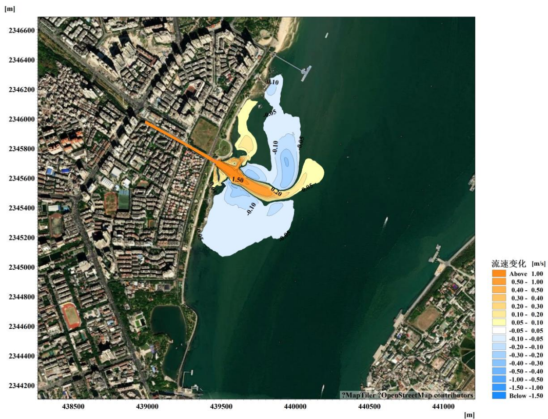
图 5.1.2-17 工程前、后涨急时刻流速变化等值线图（开闸，设计流量 126.82\text{m}^3/\text{s} ）（工程后-工程前）
