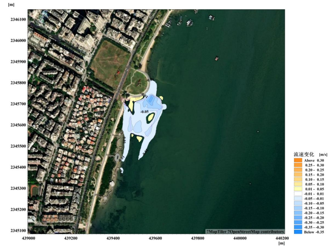
图 5.1.2-16 工程前、后落急时刻流速变化等值线图（开闸不排洪）（工程后-工程前）
