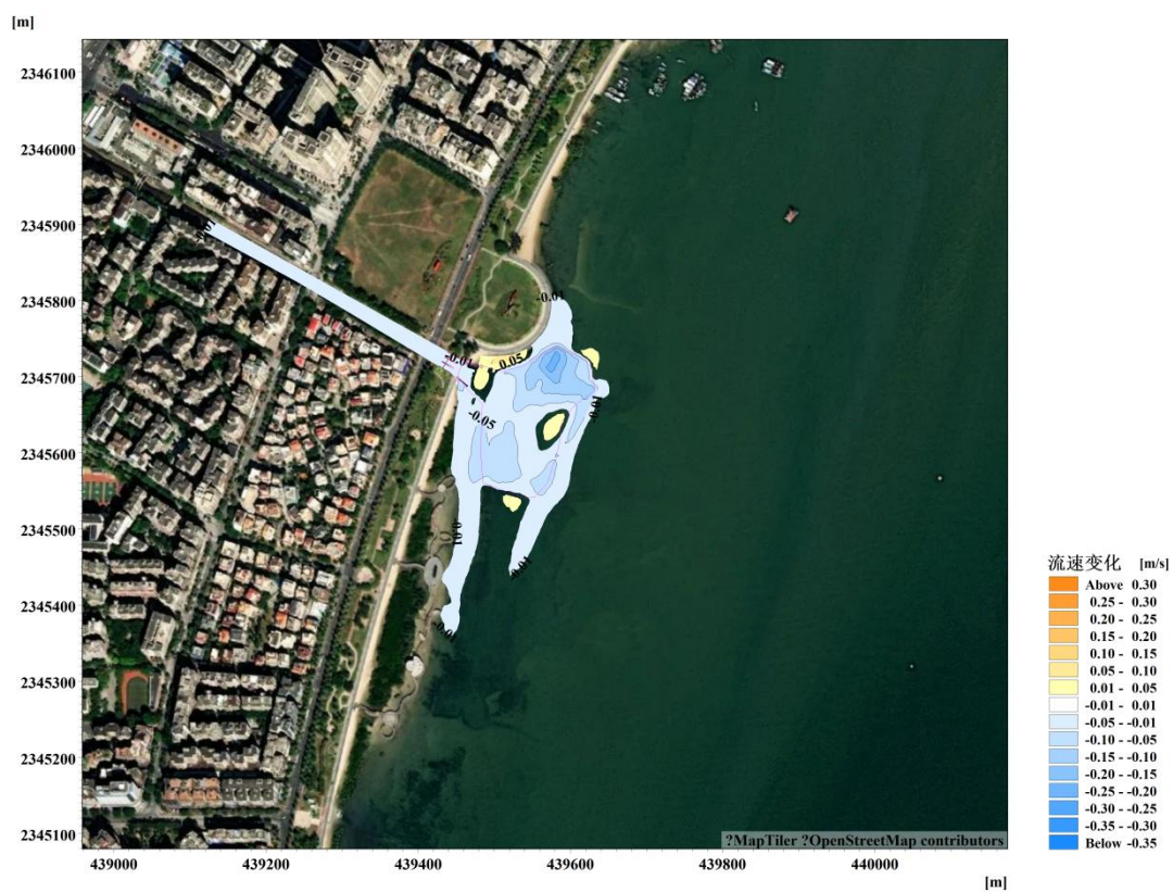
图 5.1.2-14 工程前、后落急时刻流速变化等值线图（闭闸）（工程后-工程前）
