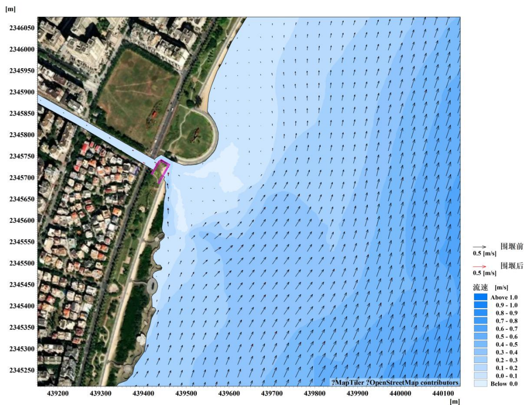
图 5.1.2-10 施工期围堰前、后涨急时刻项目附近海域流场对比图
