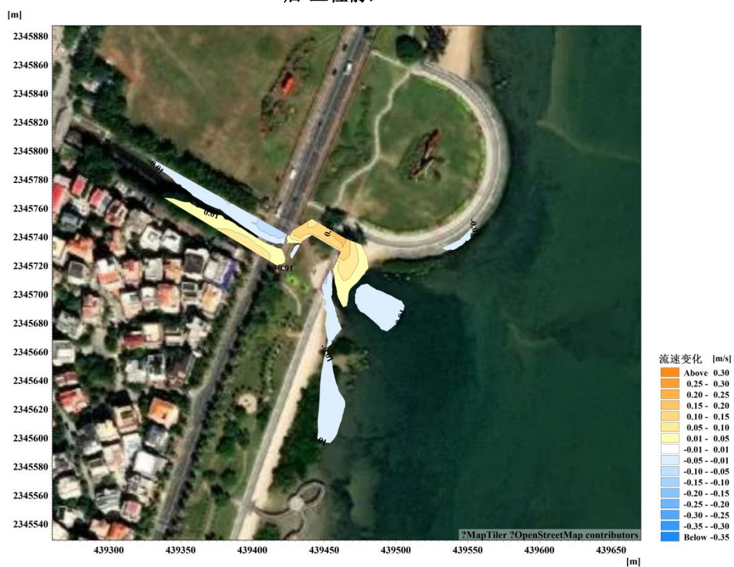
图 5.1.2-18 工程前、后落急时刻流速变化等值线图（开闸，设计流量 126.82\text{m}^3/\text{s} ）（工程后-工程前）
