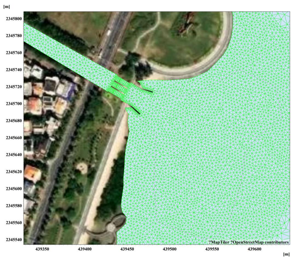
图 5.1.1-3 本项目实施后项目海域网格剖分示意图（开闸）
