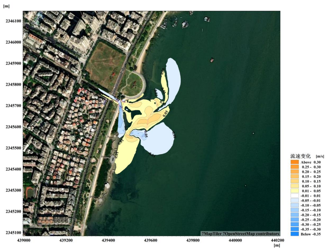
图 5.1.2-15 工程前、后涨急时刻流速变化等值线图（开闸不排洪）（工程后-工程前）
