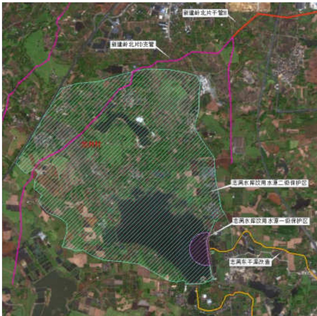
图3.2-17 工程布置与志满水库水源保护区位置关系示意图
