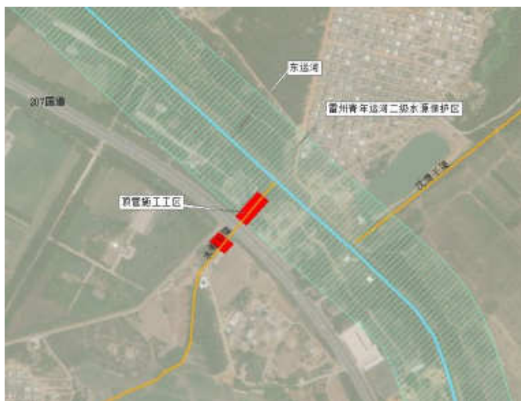
图3.2-14 东运河段水美干渠工程布置与青年运河水源保护区位置关系示意图
