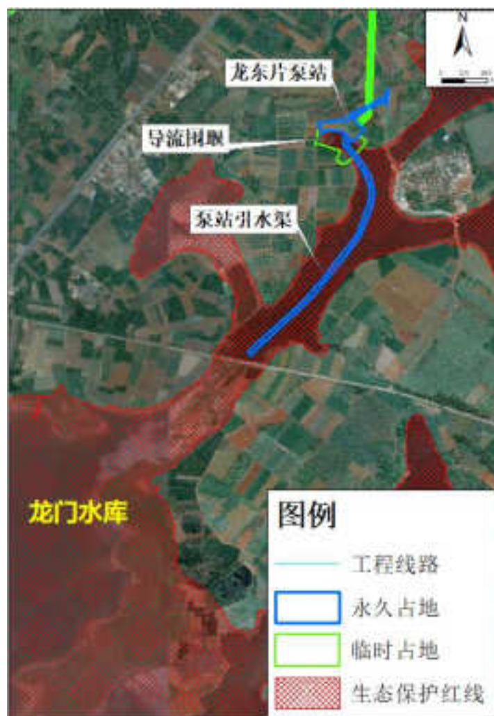
图3.2-10 雷西南龙东片泵站占地与生态保护红线位置关系示意图
