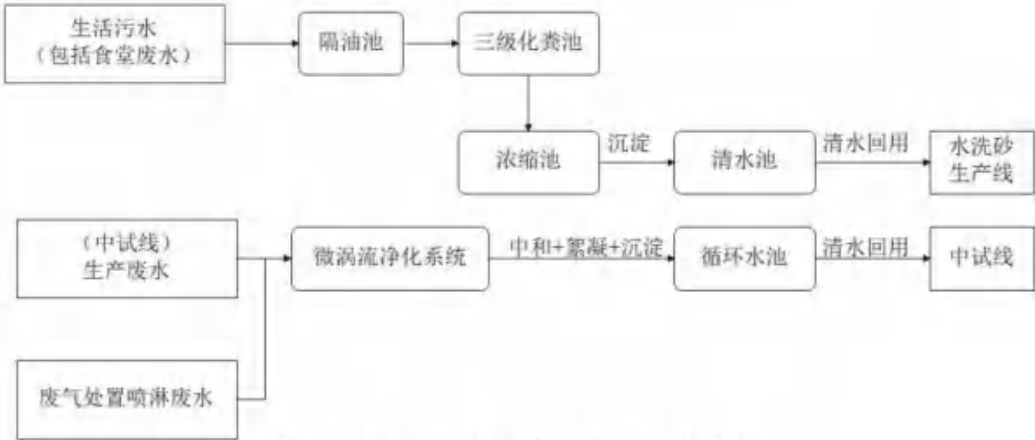
图 4-2 (现有项目) 污水处理工艺流程
