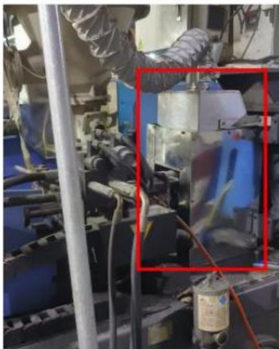
图 4-2 参考案例项目挤出废气集气罩设置现场照片
