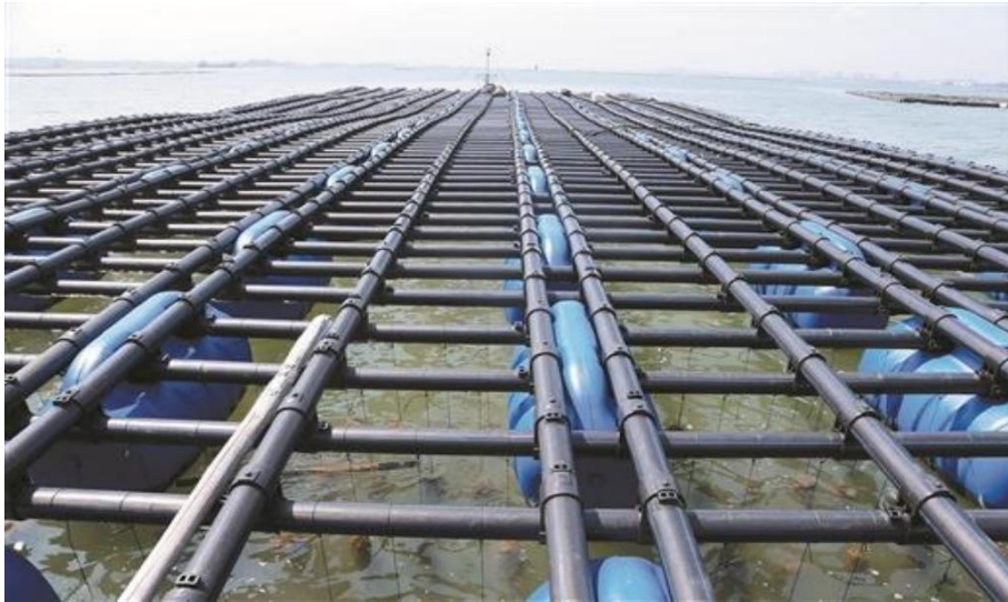
图 3.3.4-1 筏式养殖栅架（新型抗风浪筏式养殖装备）结构
