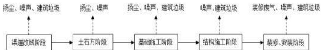
图 2-2 施工期工艺流程及产污环节图
