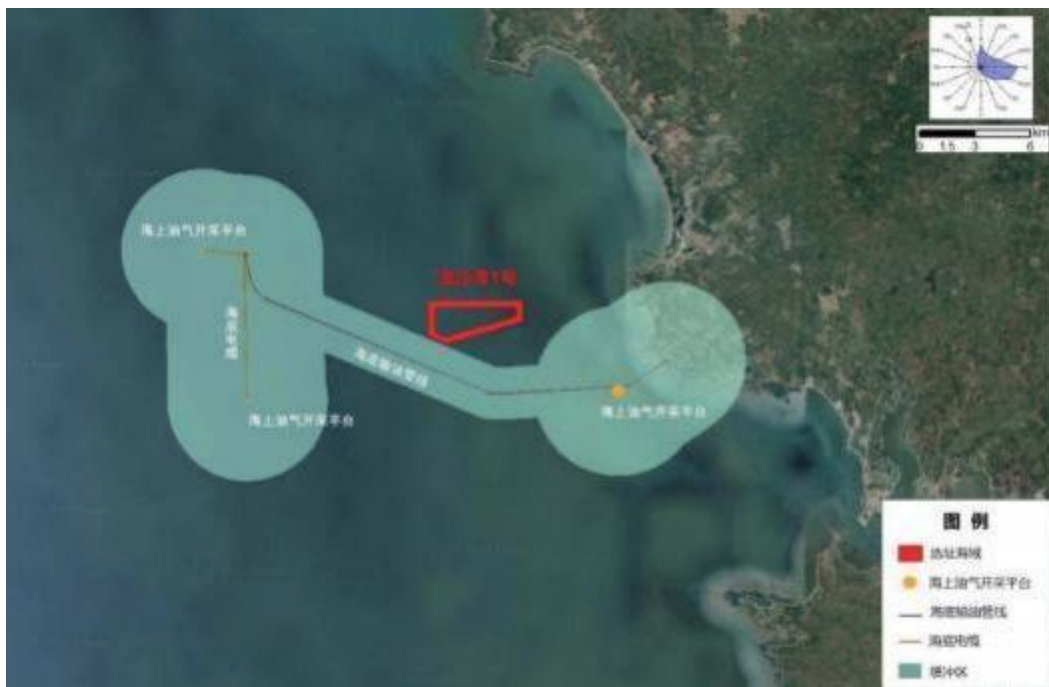
图 4.5-5 项目用海与海底电缆管道叠置图
