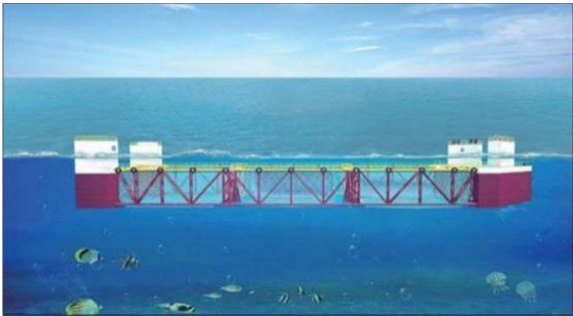
图 3.4-9 桁架类网箱养殖示意图
