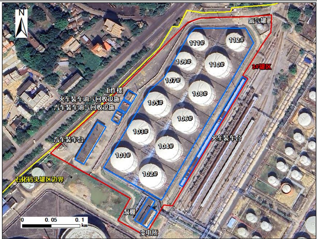
图 2.3-4 3#罐区实际建设平面图
