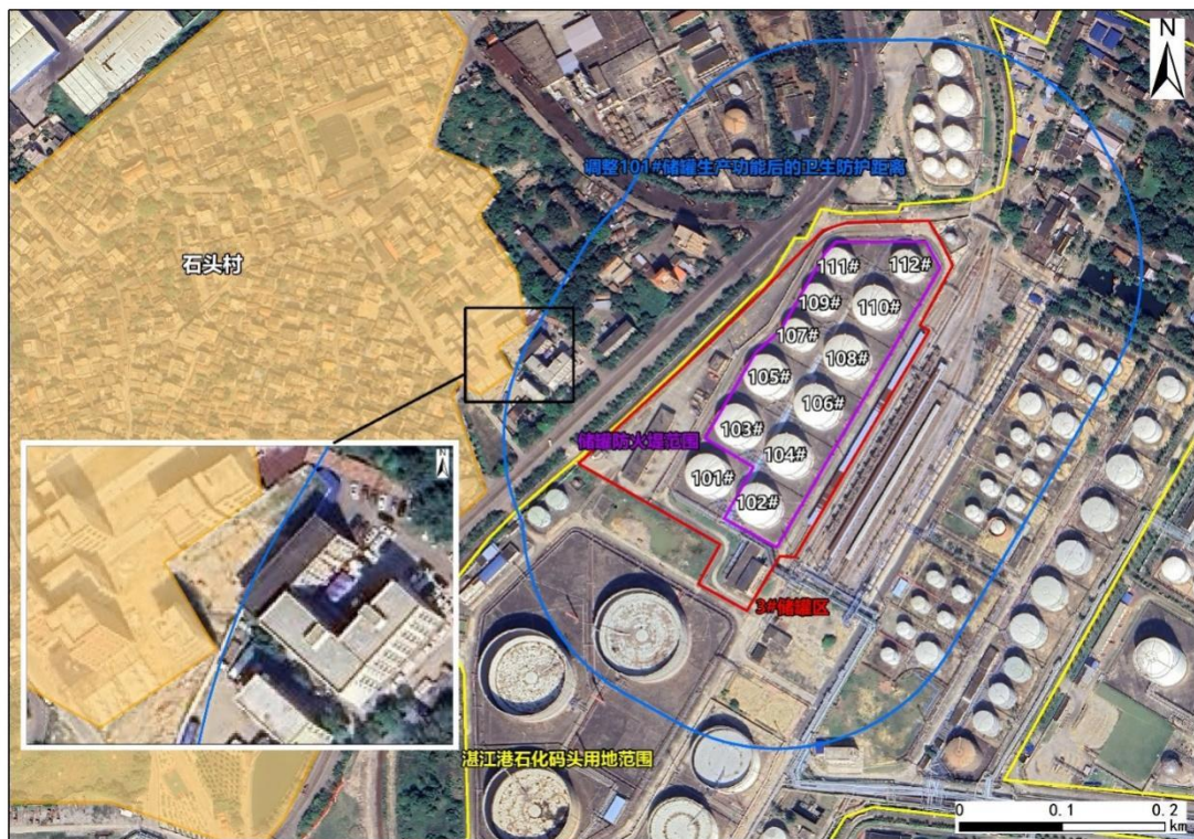
图 4.3-4 调整储罐生产布局后本项目卫生防护距离与现状环境敏感区的位置关系图
