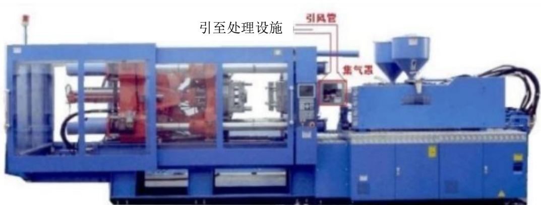
图 11 项目注塑机集气罩位置照片（图样）
