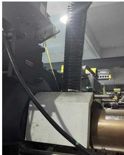
图 10 包围型集气罩位置照片（图样）
