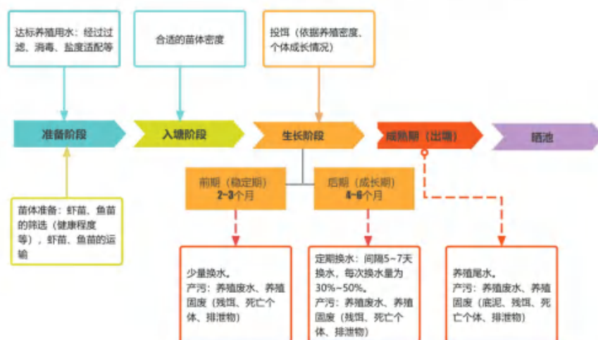
图 2.2.3-1 养殖工艺流程及产污环节图
