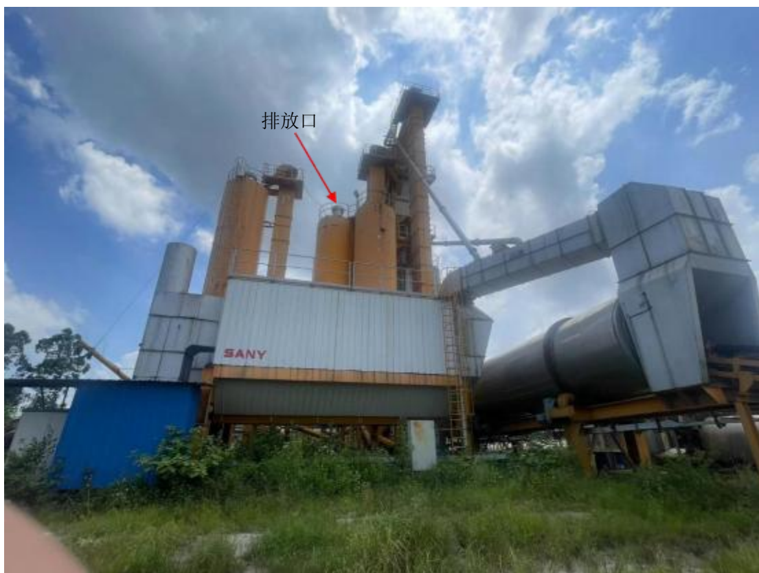
图 2-6 矿粉筒仓仓顶呼吸粉尘滤芯式布袋除尘器+15 米排放口（DA005）
