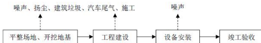
图2-5 施工阶段工艺流程及产污示意图
