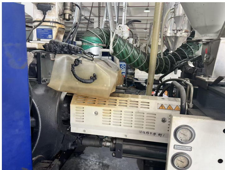
图 4-1 同类型项目注塑机集气罩案例
