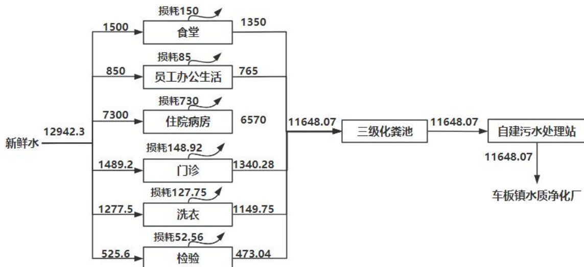
图 2-1 扩建后水平衡图 (m³/a)
