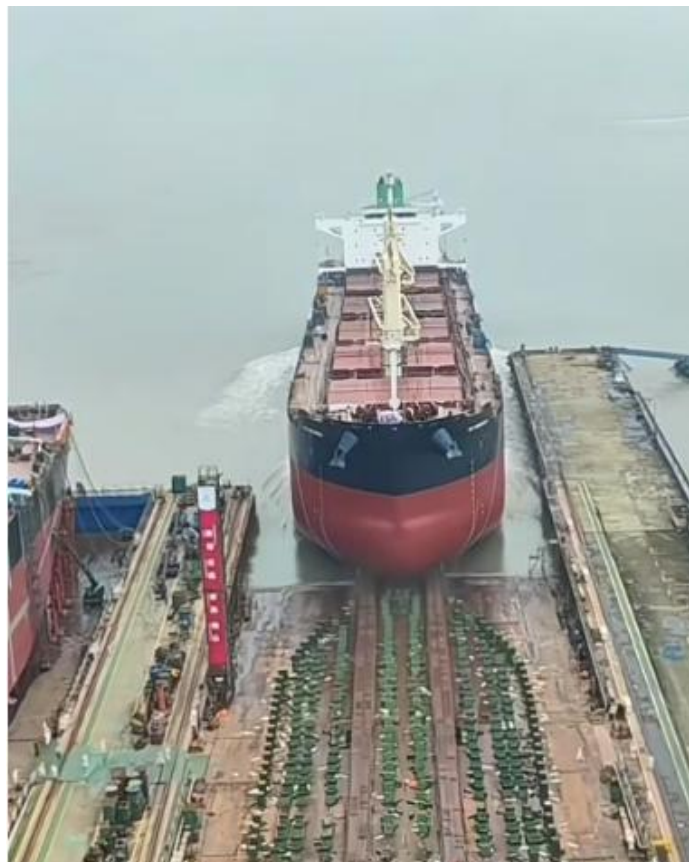
图 3.1-7 船舶利用滑道、轨道上陆示意图（其他已建项目示意）
