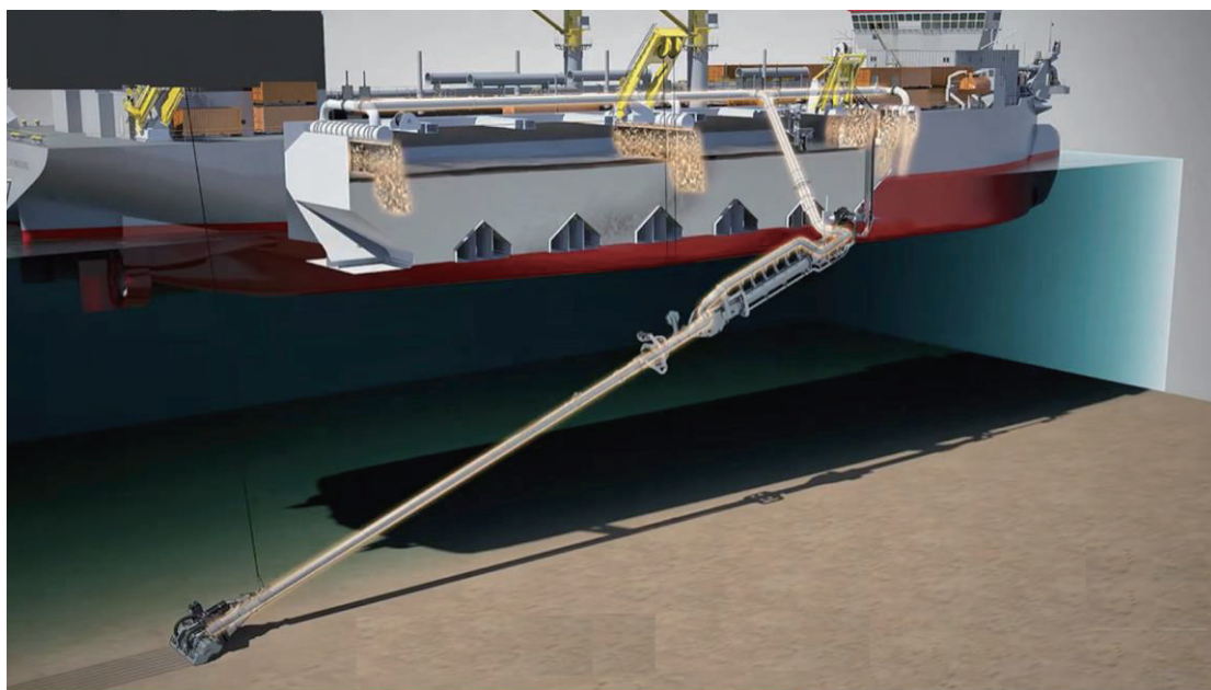
图 2.4.1-2 耙吸船施工示意图
