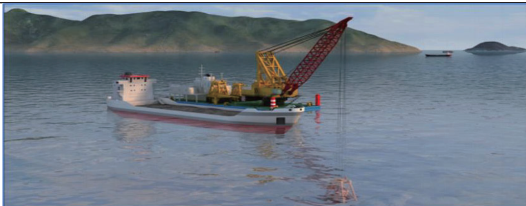
图 2.4.1-1 抓斗挖泥船施工示意图
