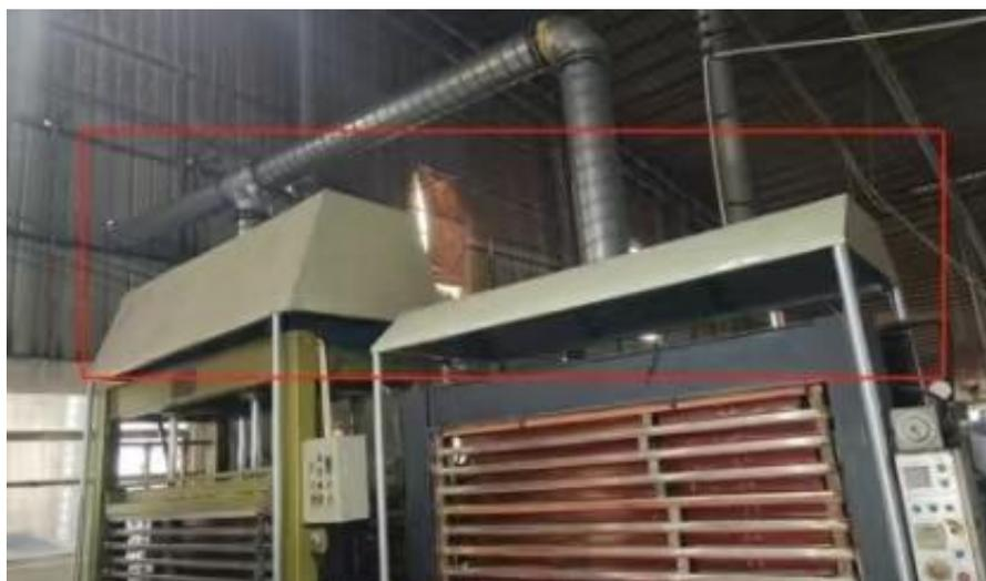
图4-1. 胶合机废气集气罩设置情况
