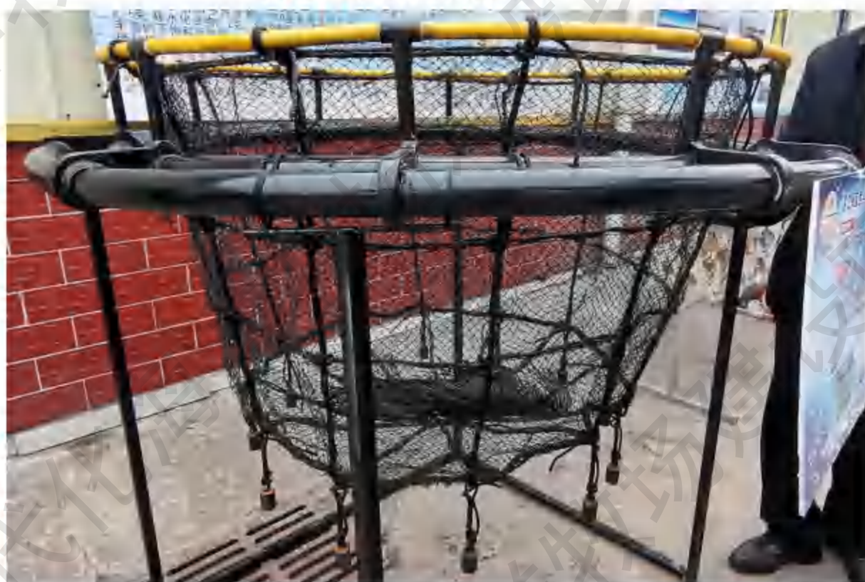
图 3.2-19 重力式网箱网衣模型图
