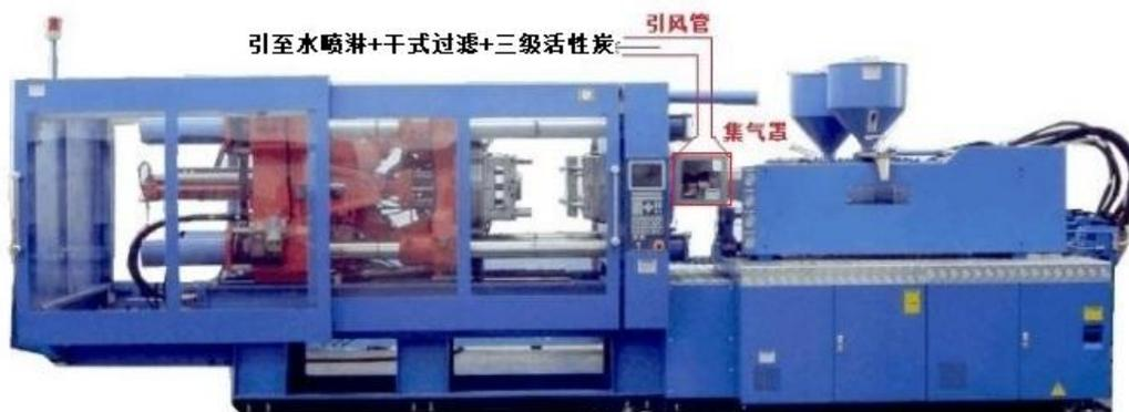
图 4-2 注塑机废气集气罩示意图
