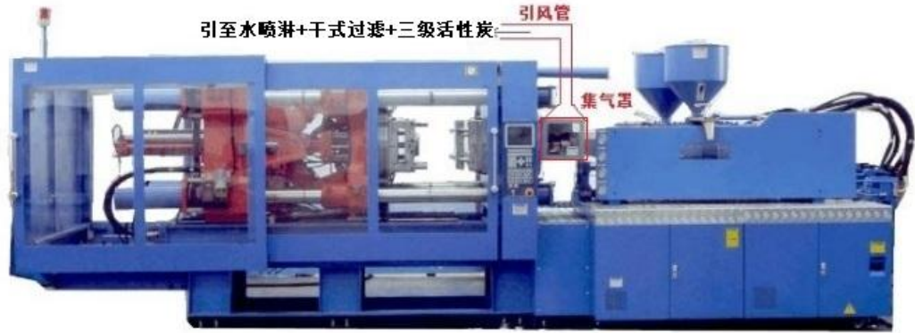
图 4-2 注塑机废气集气罩示意图
