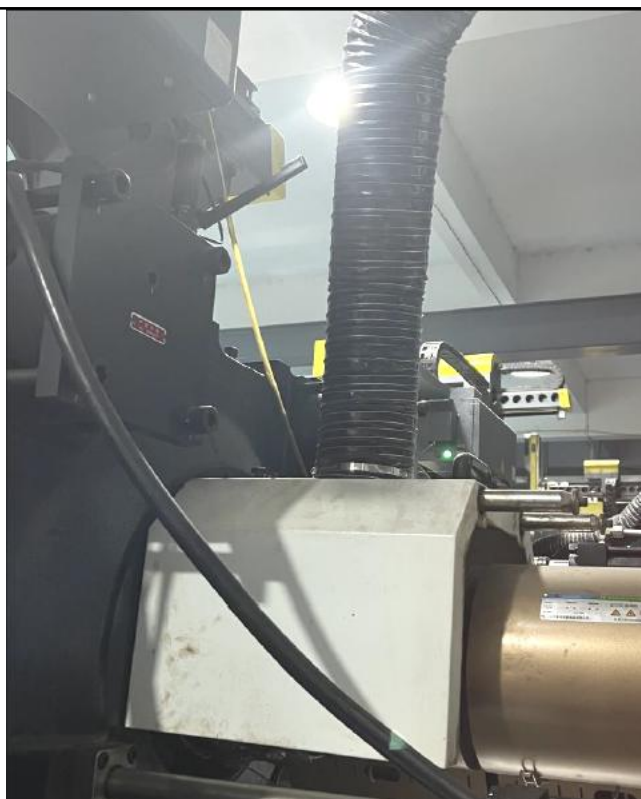
图 4-1 项目包围型集气罩效果照片
