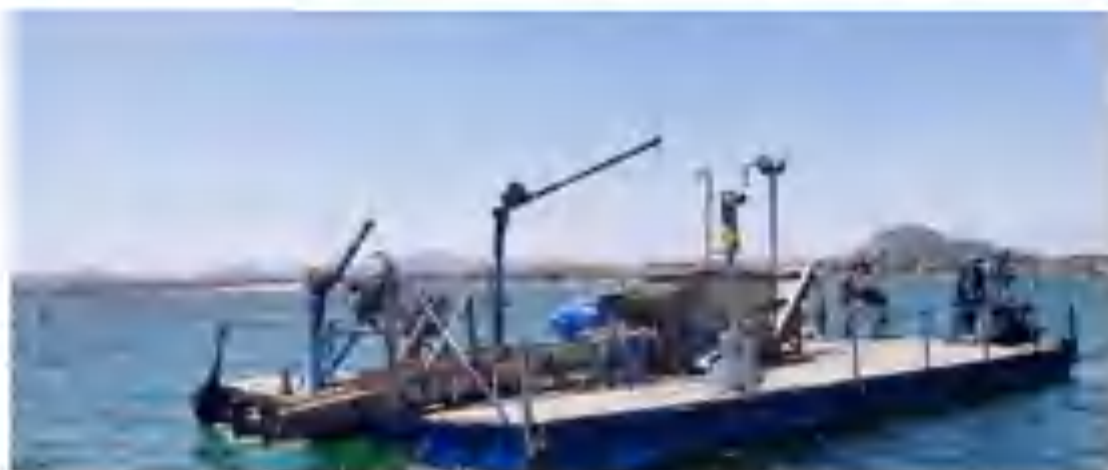
图 2.4.2-5 牡蛎筏式养殖的机械化采收
