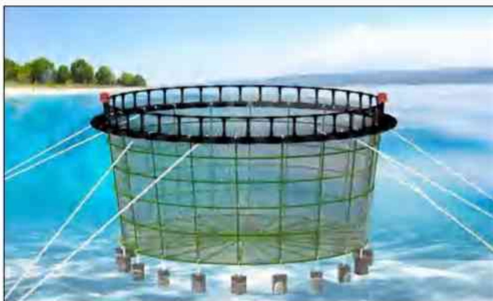
图 2.2.5-1 重力式深水网箱结构示意图
