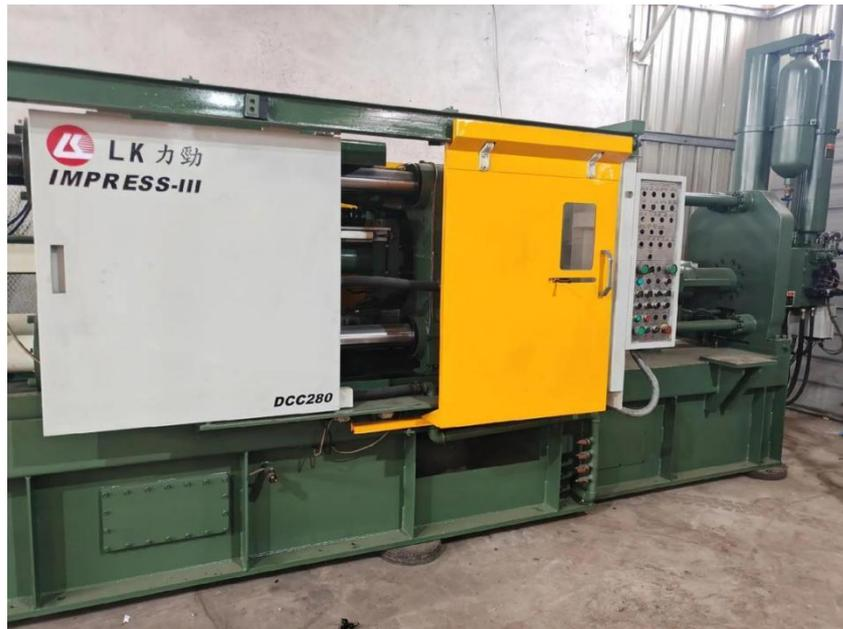
图2-3 铸造机样图
