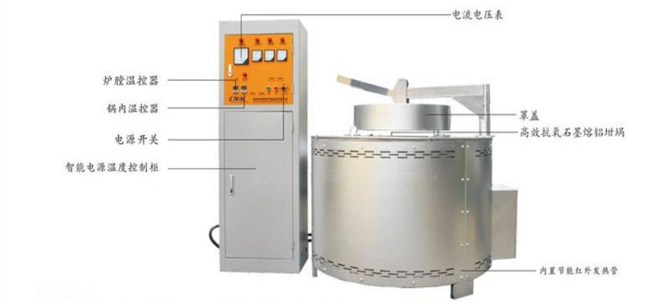
图2-1 铸造机配套红外线熔铝炉示意图
