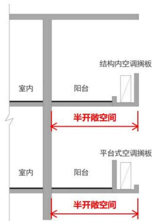
图 5 结构内的空调搁板、平台式空调搁板示意图
