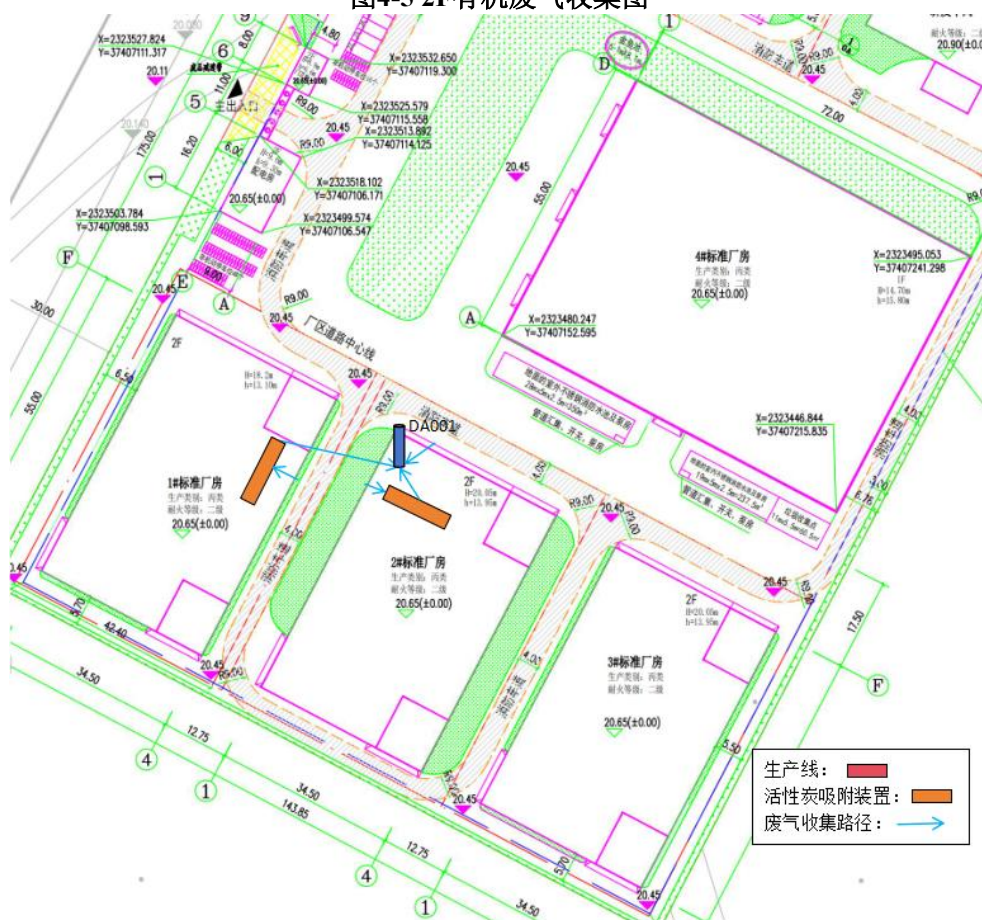
图4-6 楼顶有机废气收集图
