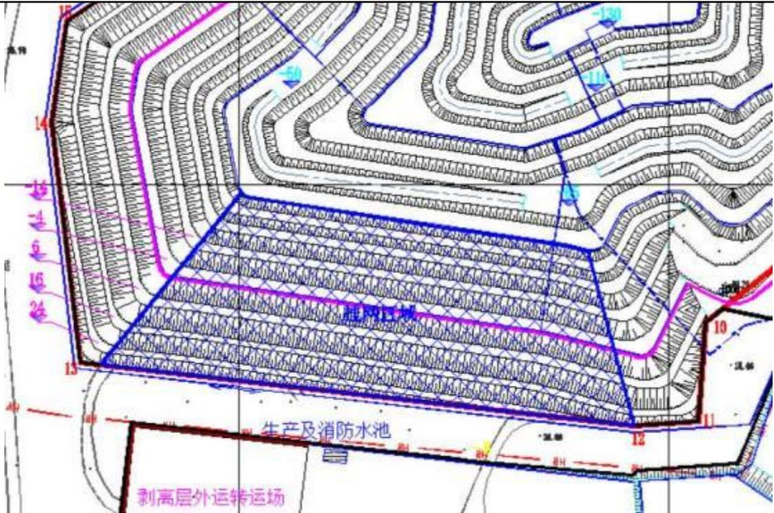
图 5-3 露天采场南侧边坡挂网布置图
