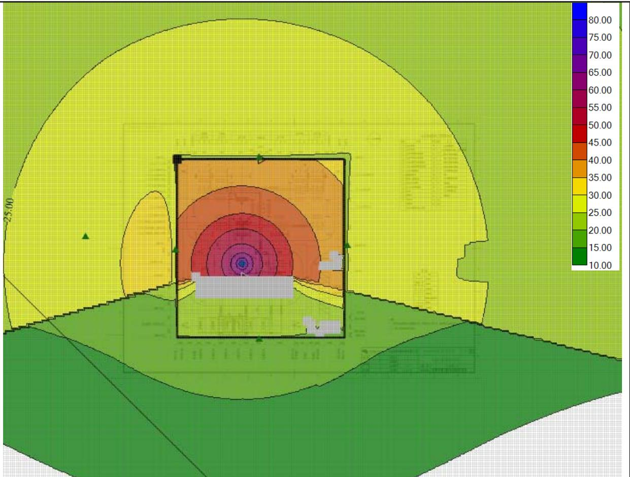
图 4-2 主变噪声预测等声值线图
