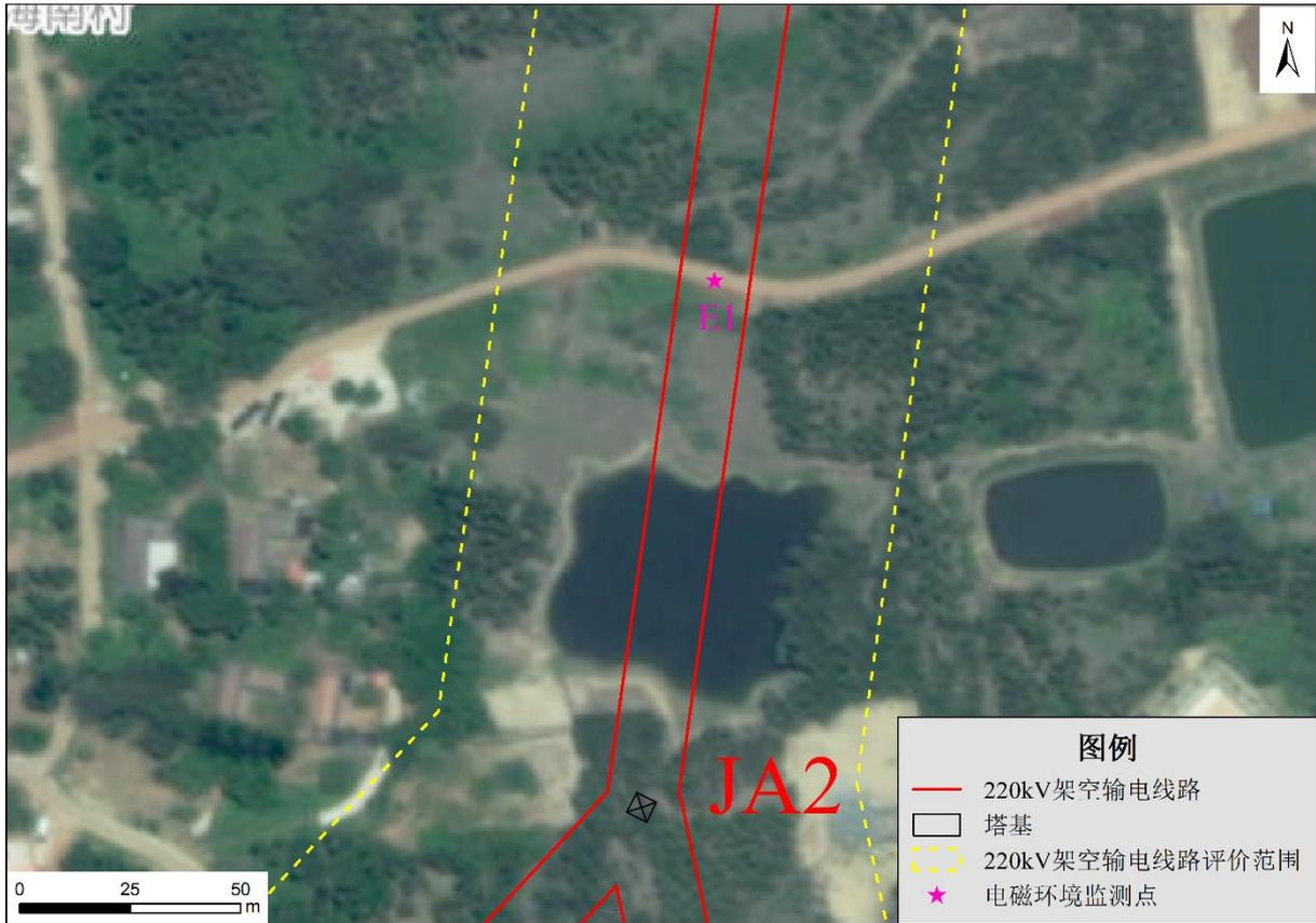
图I-6 220kV输电线路典型线位1处电磁环境监测布点示意图
