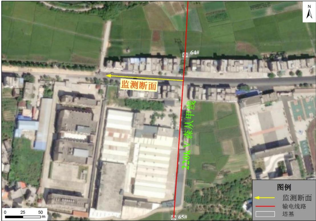
图 18 220kV 森从甲线断面监测布点示意图
