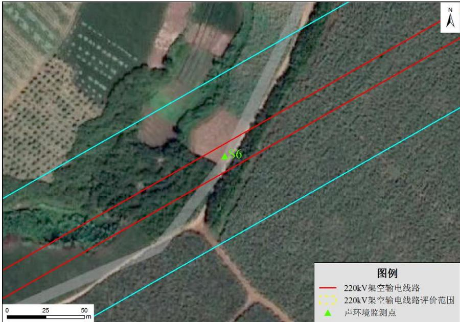
图 10 220kV 输电线路典型线位 2 处声环境监测布点示意图
