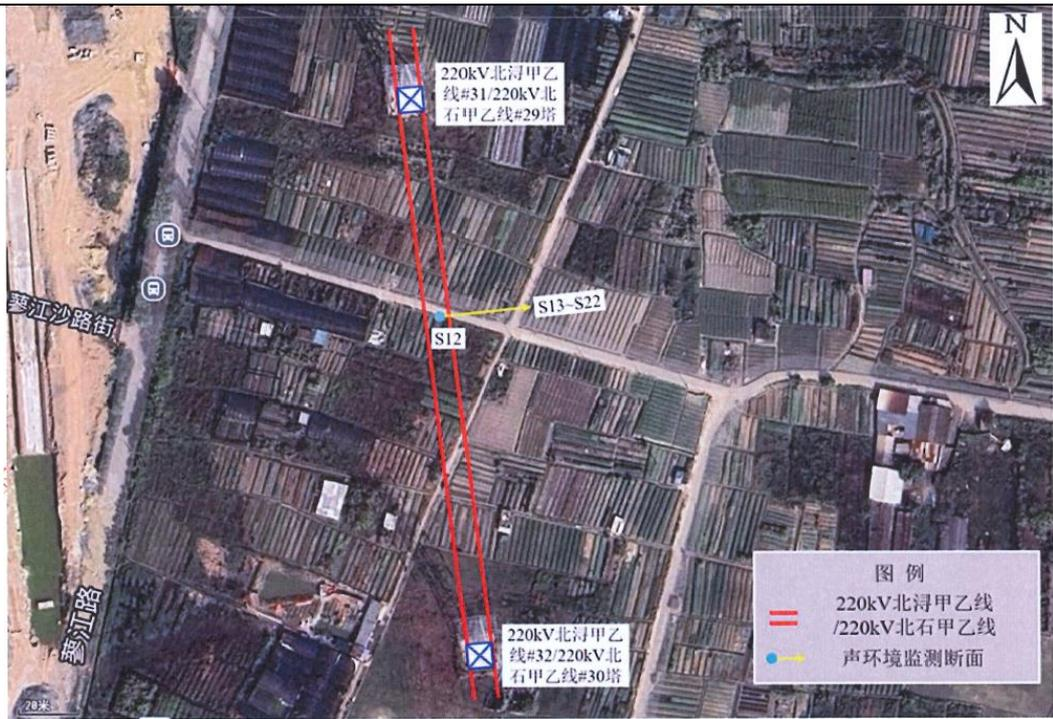
图 20 220kV北浔甲乙线、220kV北石甲乙线同塔四回线路断面监测布点示意图
