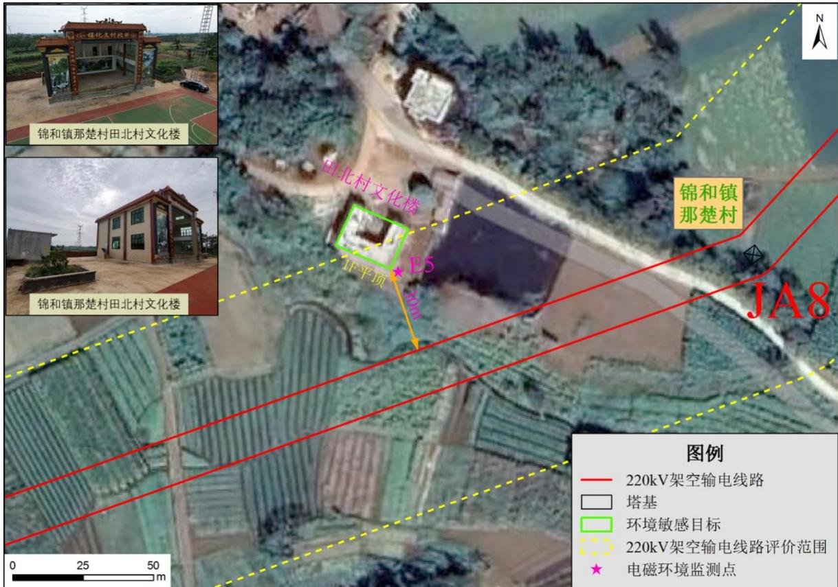
图I-4 220kV架空输电线路与环境敏感目标位置关系示意图：徐闻县锦和镇那楚村（2）
