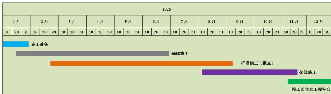
图 6 输电线路施工时序图
