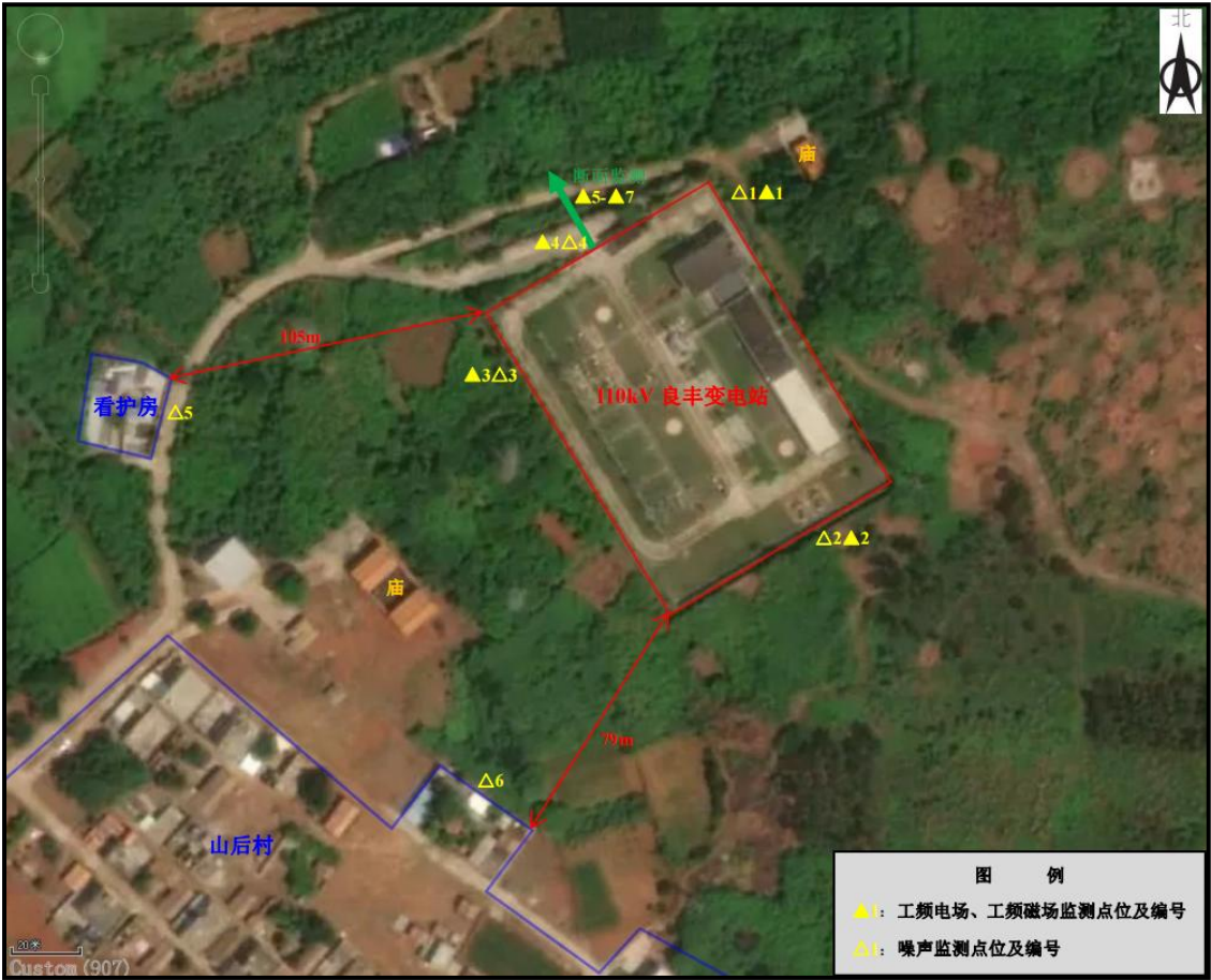
图 1 110kV 良丰变电站监测布置图
