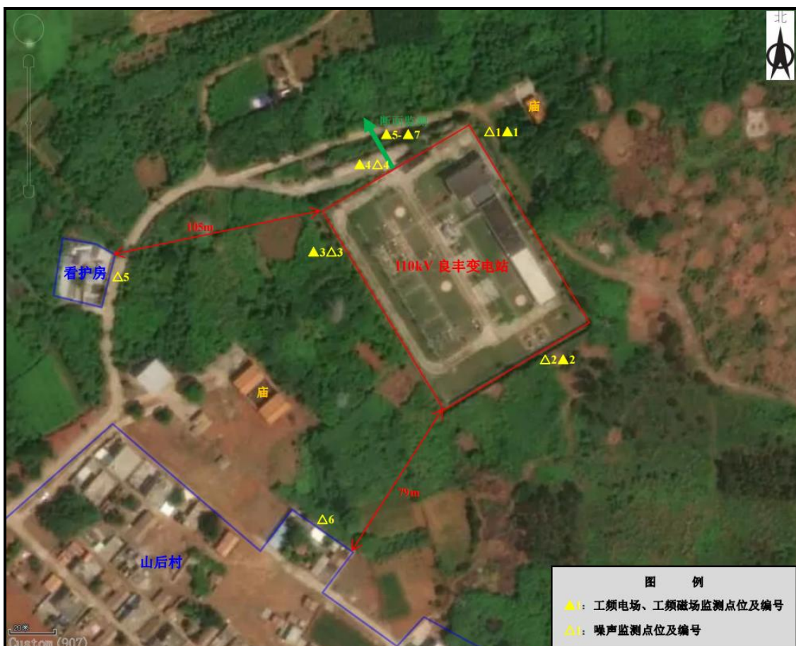
图 1 110kV 良丰变电站监测布置图
