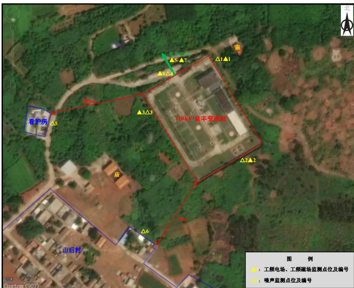
图 1 110kV 良丰变电站监测布置图
