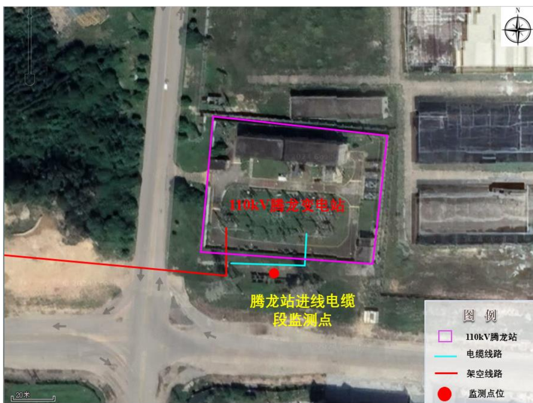
图 44 110kV 先腾线单改双线路腾龙站进站电缆线路背景值监测示意图
