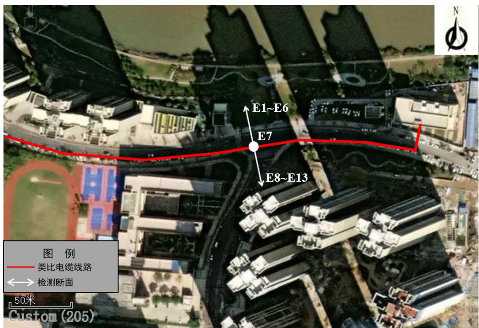
图 59 电缆线路断面工频电场、工频磁场监测布点示意图
