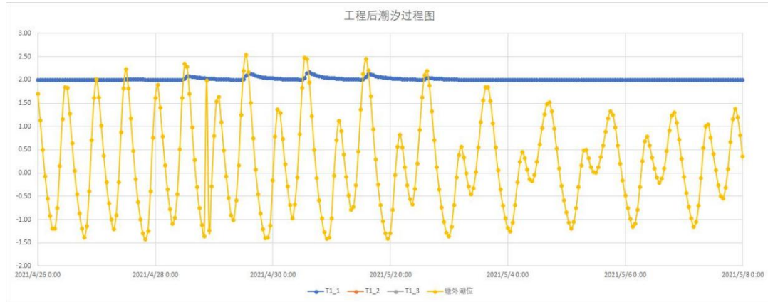
图 7.1.2-5 B03 号塘改造后开闸后塘内潮汐过程曲线图
