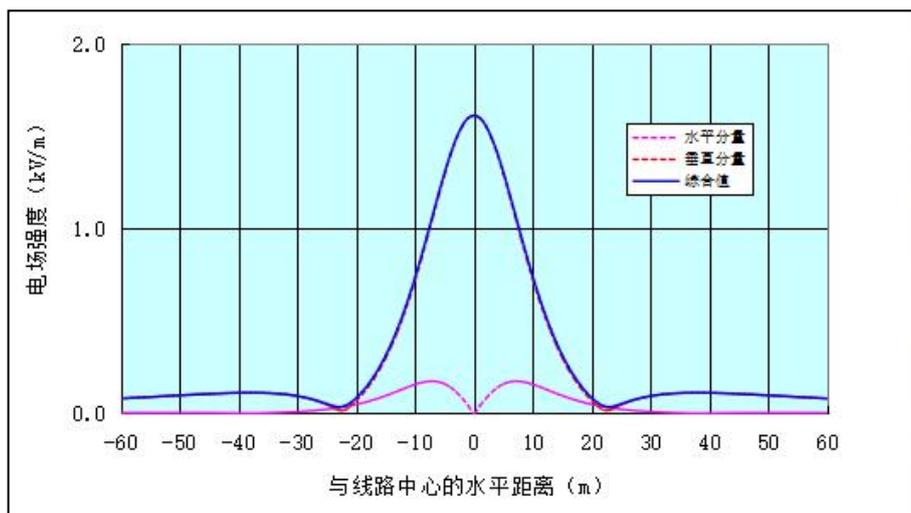
图3 理论计算 220kV 双回线路挂单边回路导线周围工频电场预测结果衰减趋势图
