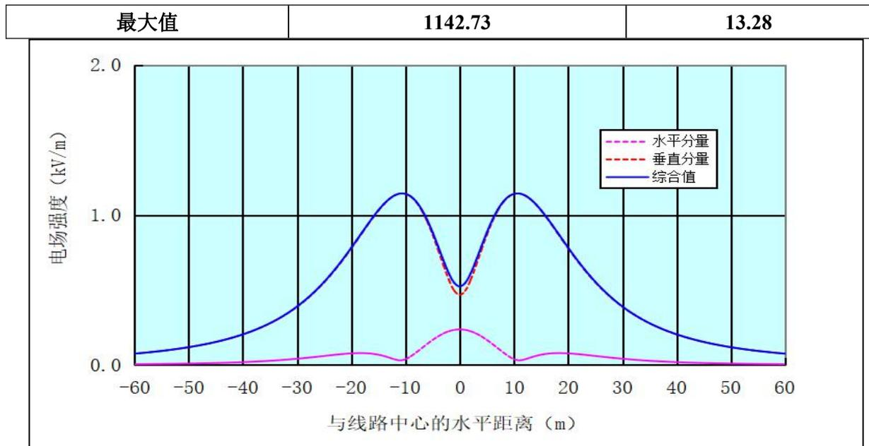
图 1 理论计算 220kV 单回线路导线周围工频电场预测结果衰减趋势图
