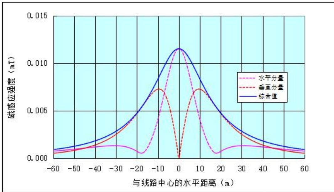
图 4 理论计算 220kV 双回线路挂单边回路导线周围工频磁场预测结果衰减趋势图
