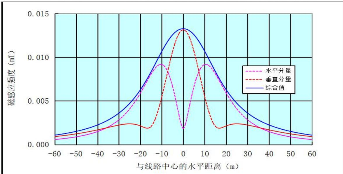
图 2 理论计算 220kV 单回线路导线周围工频磁场预测结果衰减趋势图
