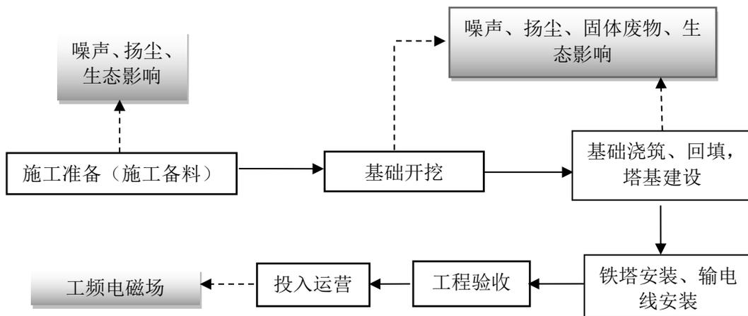
**图 2-2 本项目架空线路施工工序流程图**
