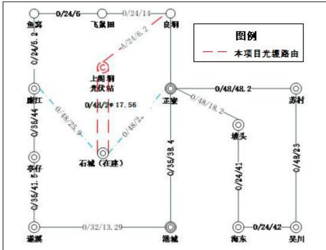
图 2-1 相关光缆建设路由图
