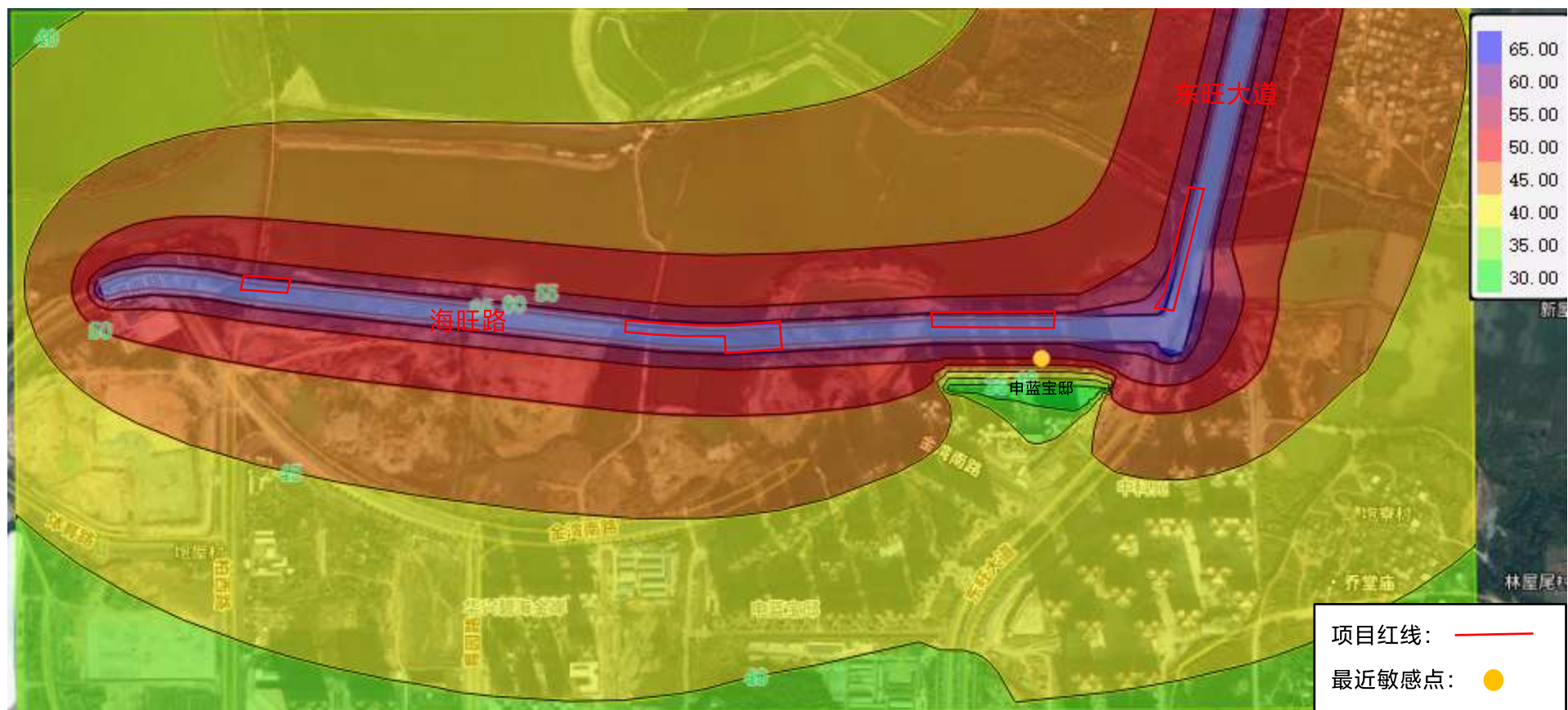
图 4-12 海旺路 1、2、3 号桥、东旺大桥远期夜间等声值线图
