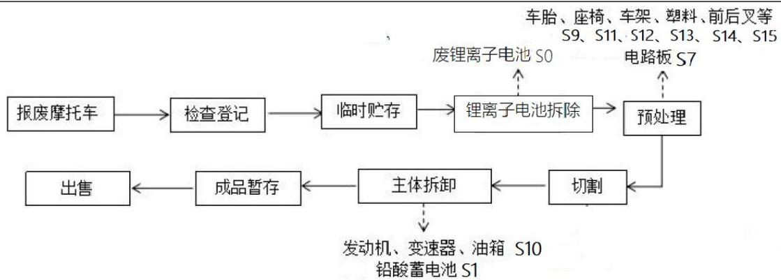
图 6 电动摩托车拆解
