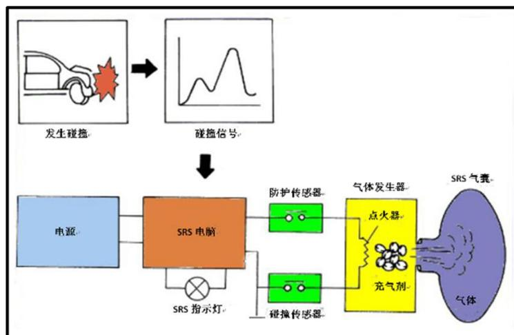
图 4 安全气囊引爆过程图
