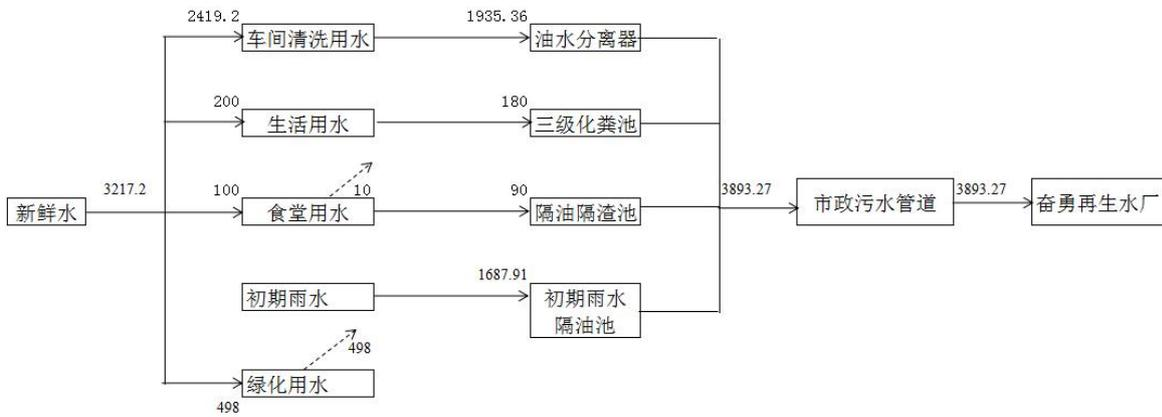
图 4-1 项目雨季水平衡图 (单位 : t/a)
