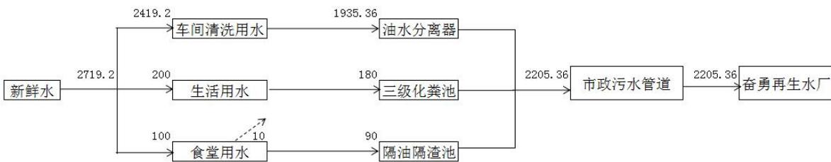
图 4-1 项目非雨季水平衡图 (单位 : t/a)
