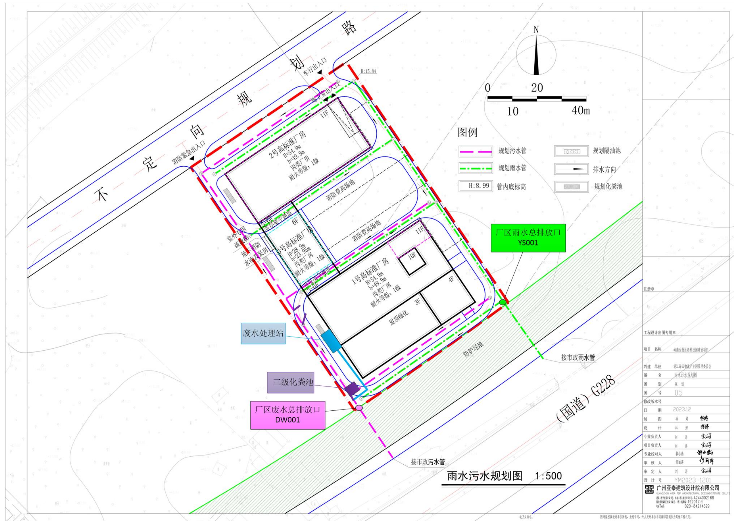
附图 5 厂房雨污管网图
