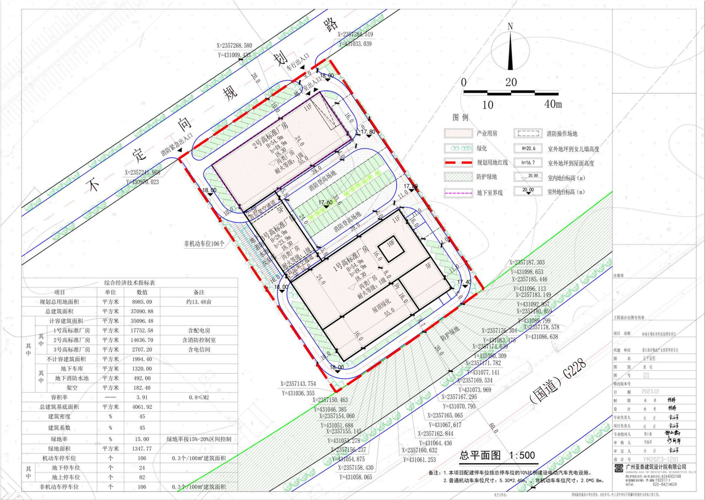
附图 4 -1 厂房总平面布置图
