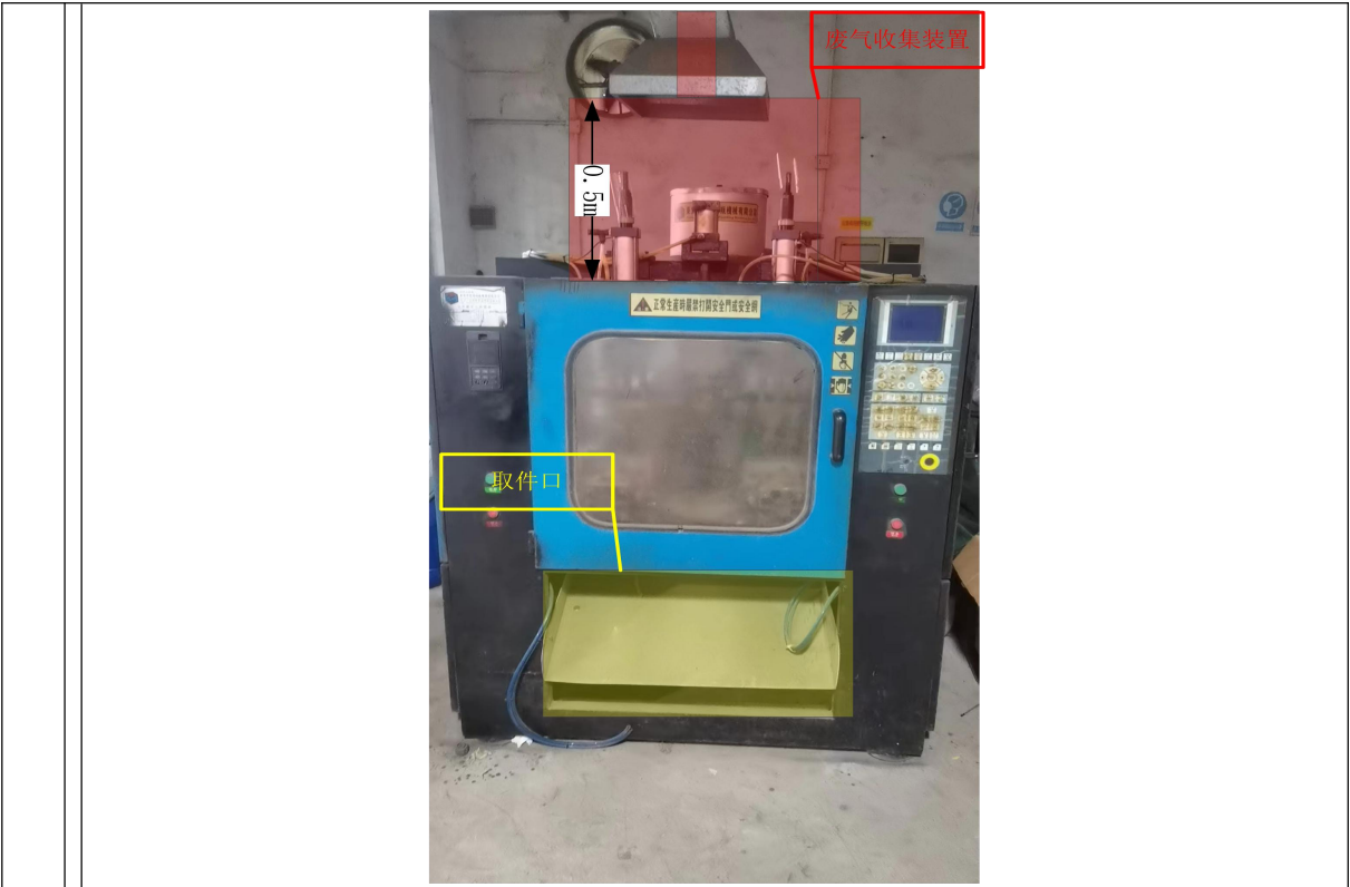
图 4-5 吹瓶机废气收集集气罩设置情况 表 4-15项目废气收集方式
