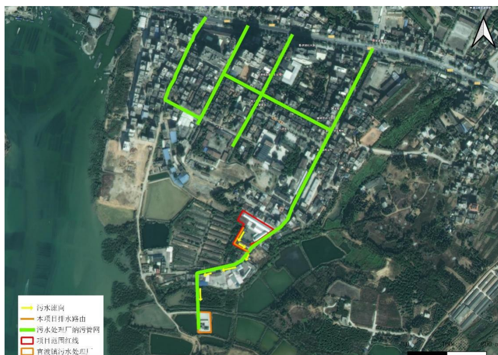
图 4-4 本项目污水排污路由图
