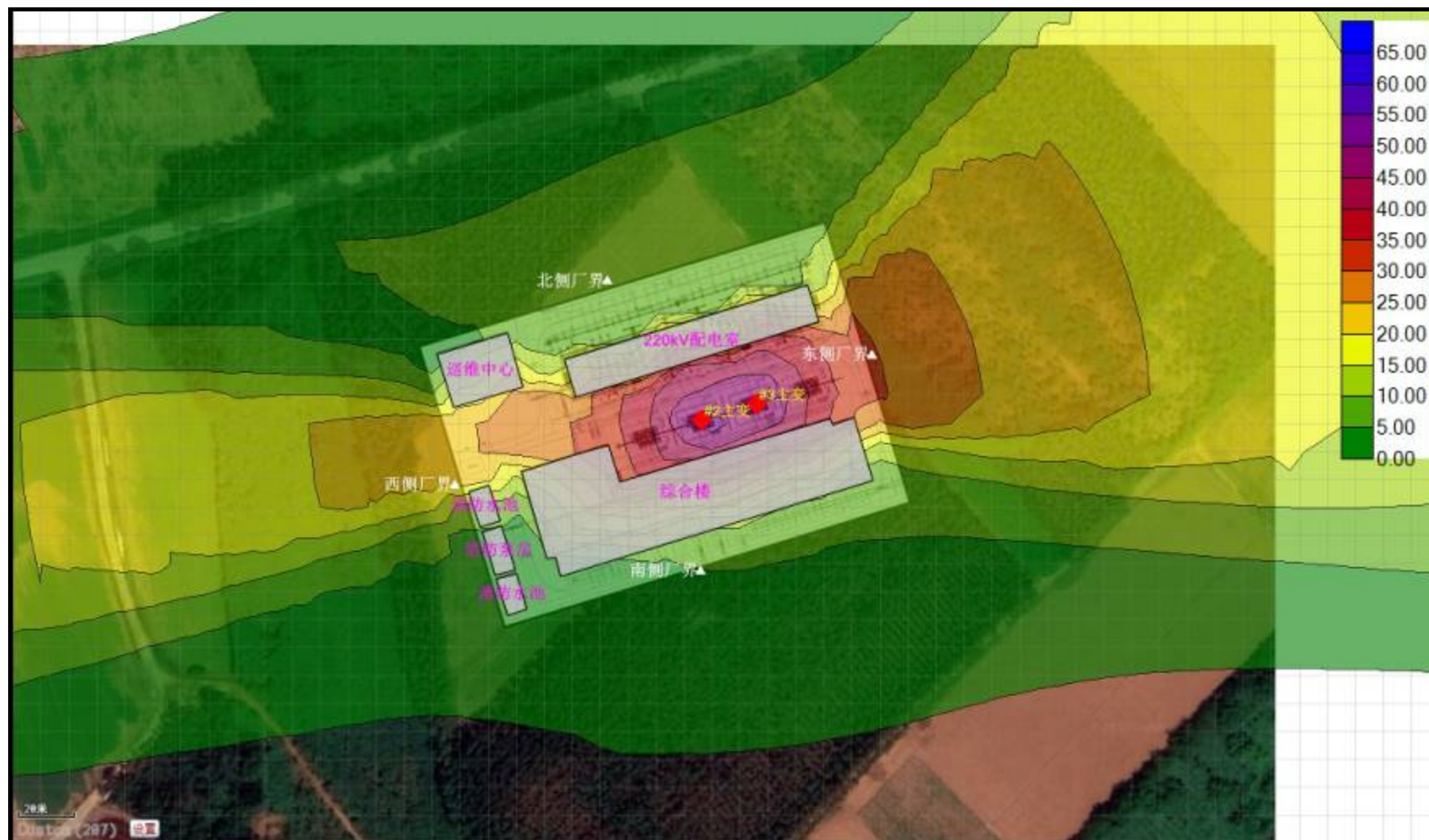
图 4-1 本项目变电站噪声预测等声级线图
