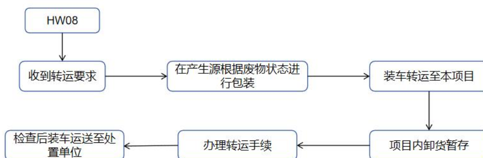
图 2-1 废矿物油收集、贮存、中转工艺流程图
