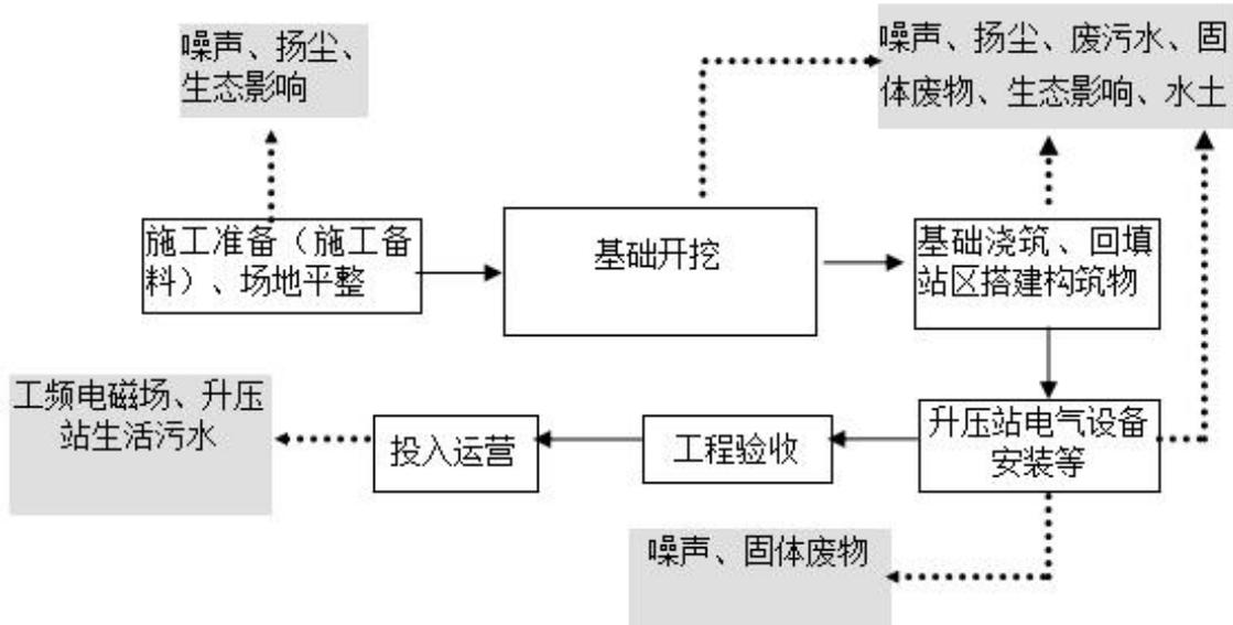
图 2-3 本项目升压站施工工序流程图
