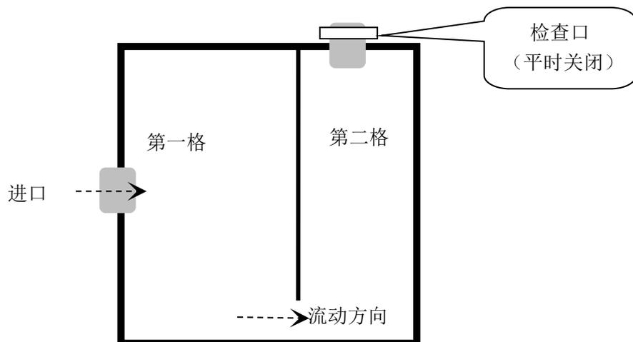
图 4-2 事故油池结构示意图
