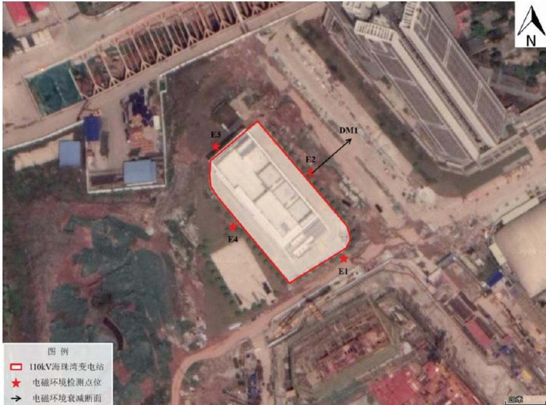
图2 类比变电站工频电场、工频磁场监测布点示意图
